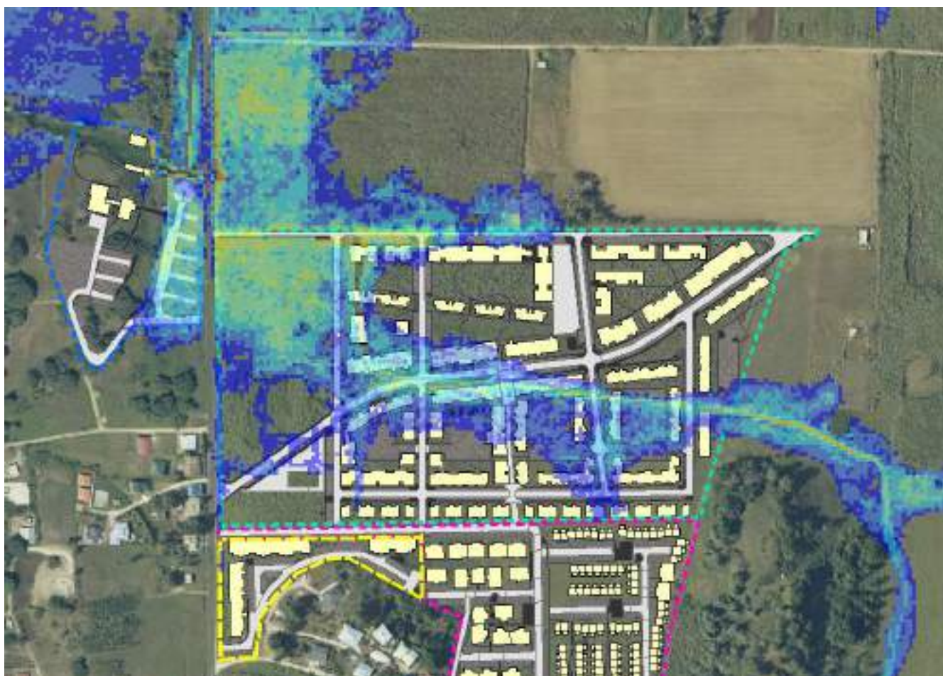
Figure 30 : Carte des zones inondées superposées aux projets de développement avec Zoom SEMAG/TAONABA (T = 100 ans, D=4h)
