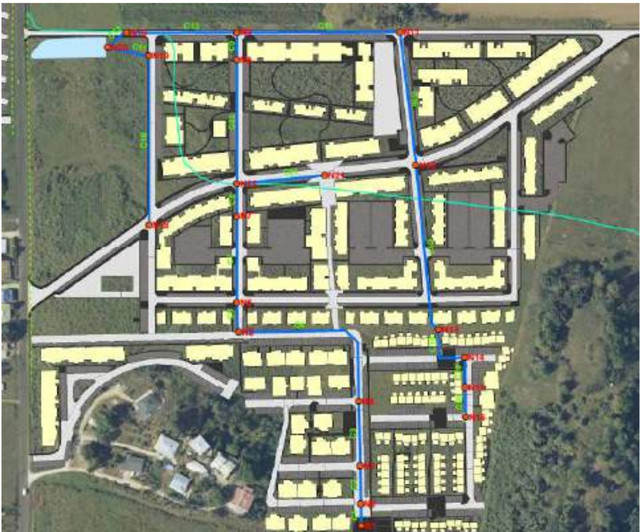
Figure 35 : Réseau structurant retenu pour pré-dimensionnement des réseaux
